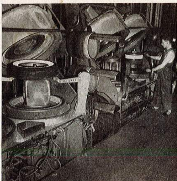
M. Vincent, cuiseur, veille à tous les facteurs influant sur la qualité finale de l'enveloppe : propreté de la carcasse et du moule, centrage de la carcasse, galbage correct. Notre photographe l'a surpris à l'instant où il venait de mouler une carcasse Flanc blanc dans un Bag-O-Matic.
