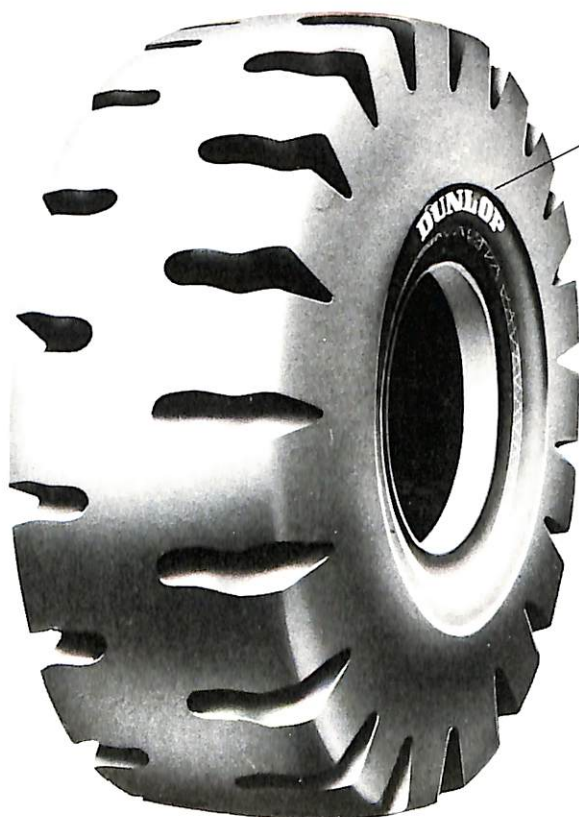
Le PG 9, pour chargement en butte de carrière, une épaisseur de gomme de 120 mm.
