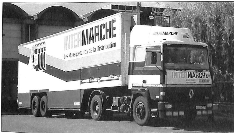
La société Trouillet vient de créer pour Intermarché un semi-remorque à deux étages : le fourgon Deupont. L'astuce : deux planchers montés sur un châssis surbaissé assurent un gain en volume et en charge de près de 60 %, sans compter l'économie de gazole. Ce châssis spécial a été mis au point
