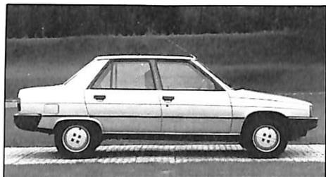
plus tard) et 6 niveaux d'équipement. Le moteur (1 100 - 1 397 cm<sup>3</sup>) est disposé transversalement avec une boîte en bout. Il s'agit d'une traction avant avec 4 roues indépendantes. Les principales qualités sont : l'économie de consommation et d'entretien, la tenue de route, le confort et, compte tenu de l'encombrement réduit (4 m 06) l'espace interne. Une
