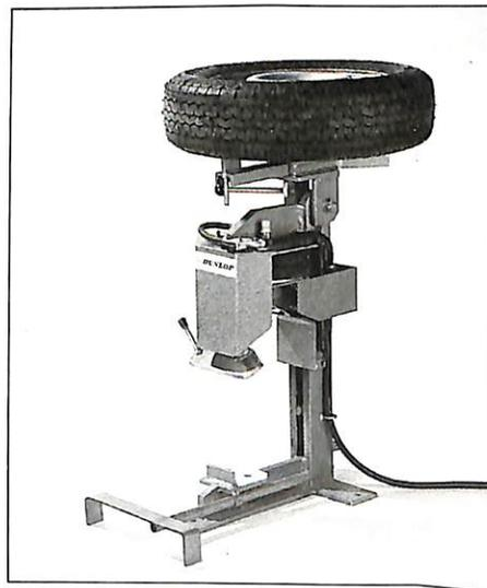
En utilisant le système Pneuride, Dunlop a développé toute une gamme de matériels pour les stations service, dont une table de montage et démontage : la TV 16.
